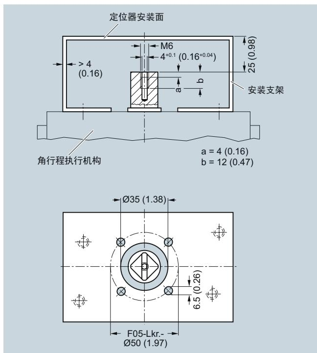
安装至角行程执行机构, 安装底座 (执行机构制造商供货范围), 符合 VDI/VDE 3845, 尺寸单位 mm (inch)
