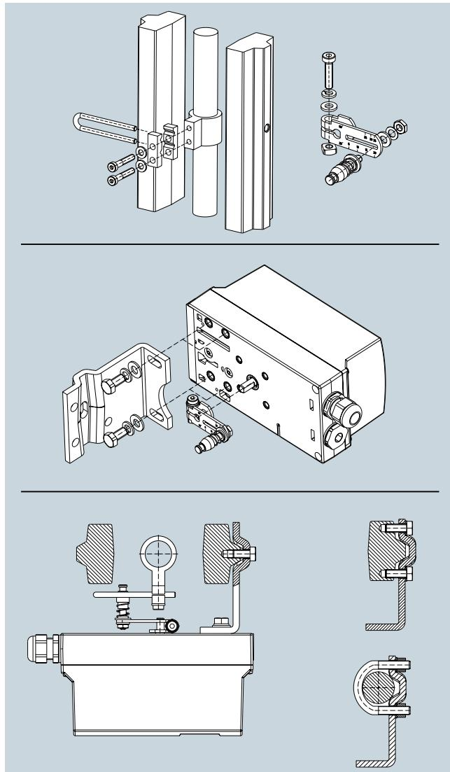
SIPART PS2 安装在直行程执行机构上
