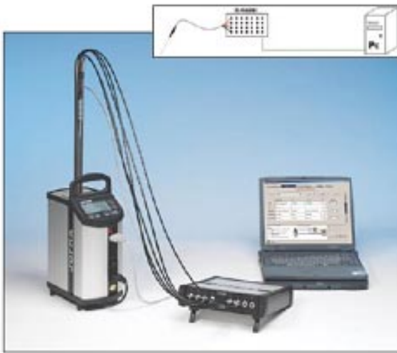
ASM-803B 与 JOFRA ITC 系列干体炉连接，利用 ASM B 系列本身具有的高精度数据采集功能，并使用 STS 参考铂电阻探头接入 ASM 通道 1，提高系统精度，整个系统会在 JOFRACAL 软件的控制下运行。
