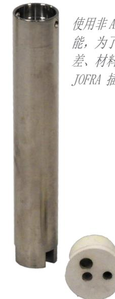
使用非 AMETEK 提供的插块可能会降低干体炉性能，为了得到最好的校准结果，插块的尺寸、公差、材料等至关重要。我们强烈建议使用 AMETEK JOFRA 插块，因为这样可以保证干体炉运行正常。
