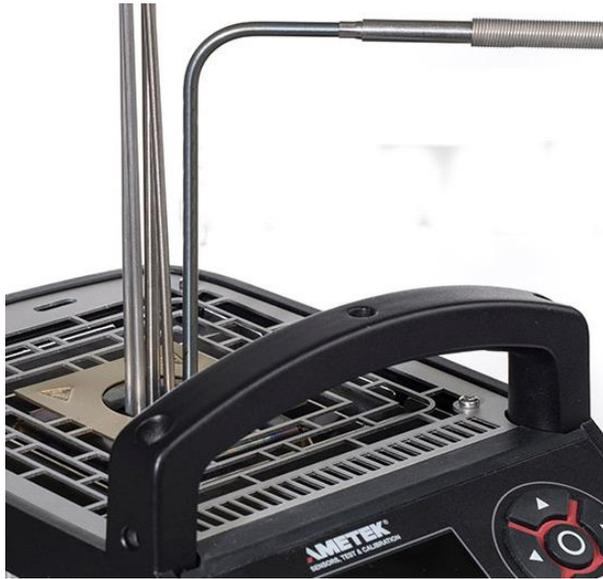
对于大多数的干体炉来说，套管热量的散失是校准较大尺寸传感器或者多支传感器时面临的挑战。CTC-1205 先进的反馈算法结合外接标准铂电阻有效的解决了热量散失问题，提高了校准精度。
