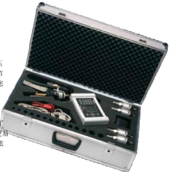
作为校准系统，**JOFRA**的校准仪表头、手泵和转接头可以装配完毕后直接放进便携箱内，现场使用时无需再进行装配！节省宝贵的校准时间！
