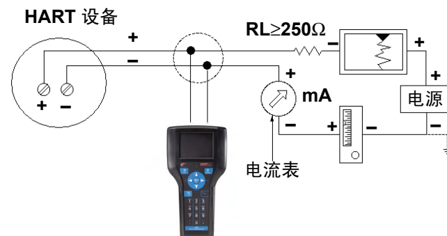
图 3-3. 连接到 HART 设备
